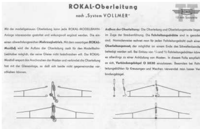
Aufbauanleitung für die Oberleitung, Betriebsanweisungen 1957
