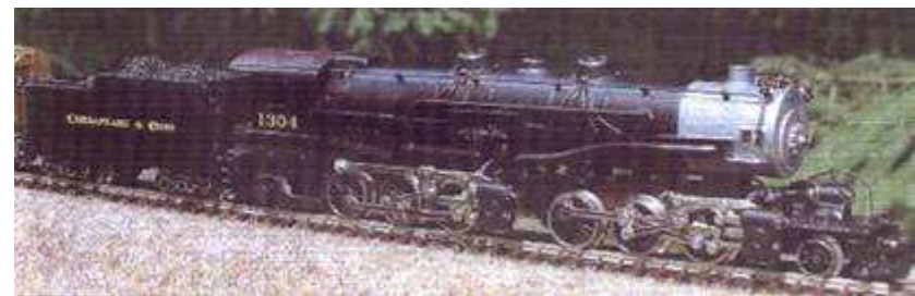
8-achsige schwere Dampflok - amerikanische Mallet-Lok (von ROKAL Konstrukteur Heinz Holterbosch gezeichnet - leider nie von ROKAL gebaut (nach Originalplänen von AKTT-Freund Christian Dühr im Jahre 2002 gebaut) - Foto: W. Knipping
